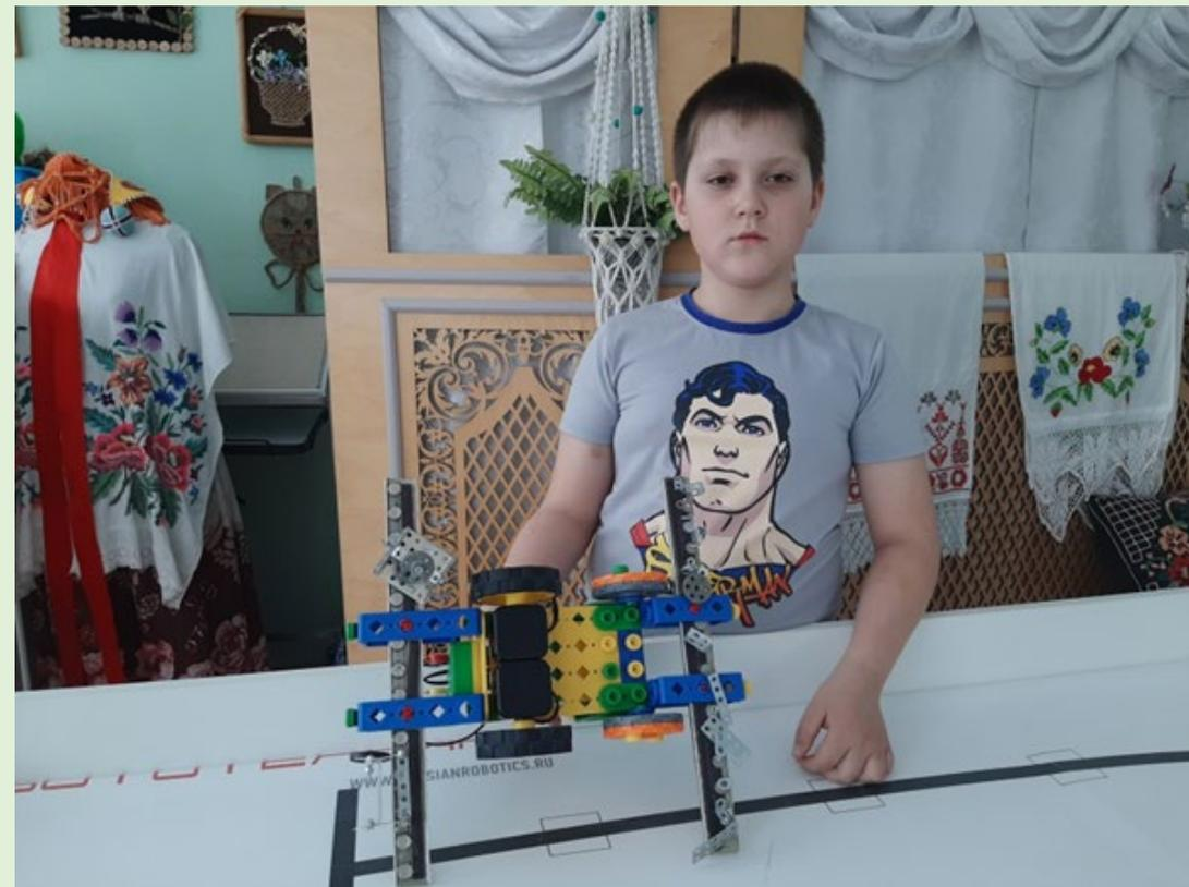
**Мы, управляя нашим роботом пи помощи пульта, направляли его таким образом, чтобы он проезжал над рассыпанными деталями и притягивал их магнитами. Передний магнит, закрепленный довольно низко от земли, предназначен для сбора мелких деталей, а задний, закрепленный выше, для более крупных.**
